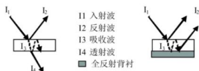
图5 吸波材料对电磁波的反射特征
